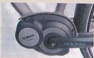
Le moteur situé dans le pédalier délivre une aide progressive.
